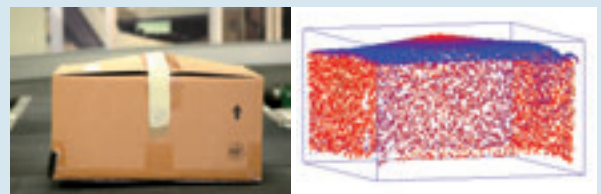
VIPAC D2 prüft die Konturen eines deformierten Kartons und erstellt daraus die entsprechenden Volumendaten
