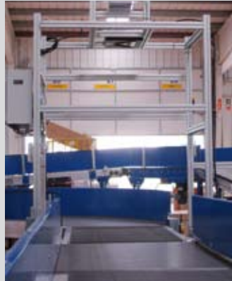
Volumenmesssysteme VIPAC D1 werden über Sortern oder Förderbändern installiert.
