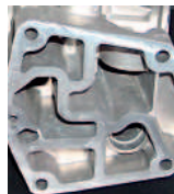
Ölfiltergehäuse, das Bild zeigt die Funktionsfläche, sind typische Bauteile, die man optisch prüfen lässt.
