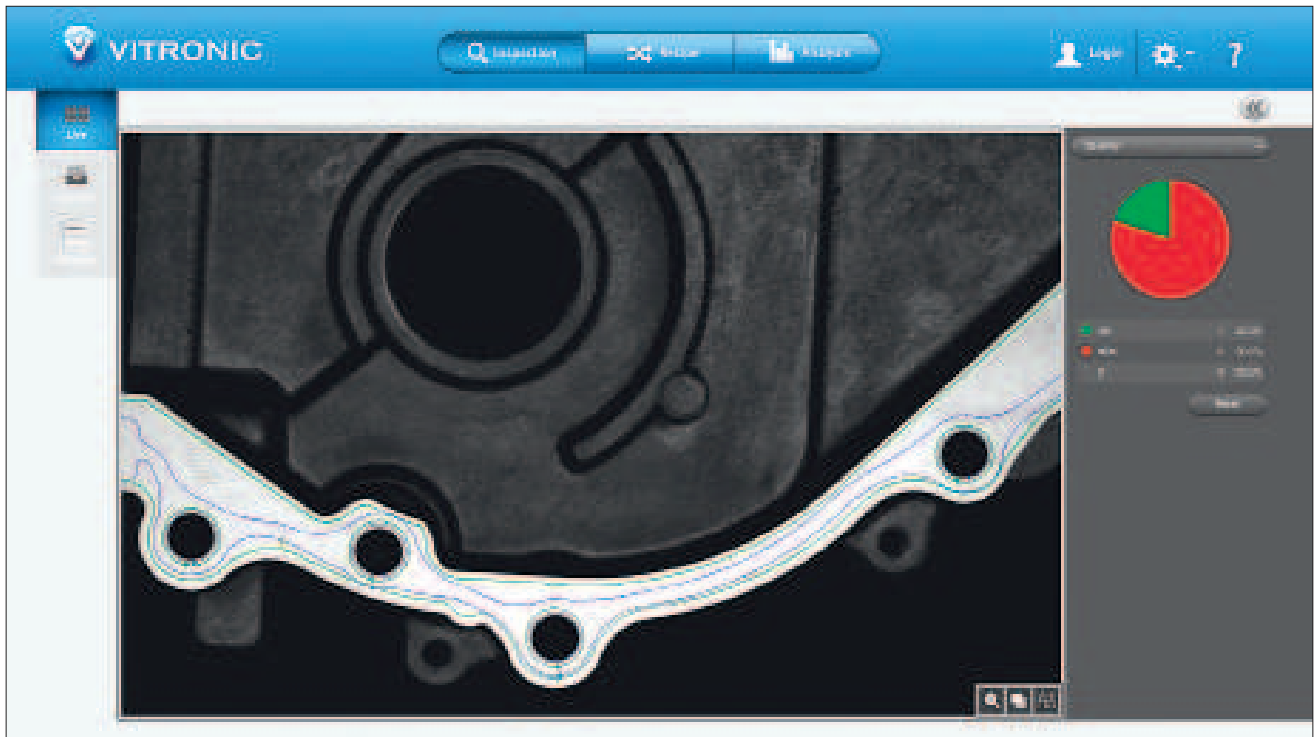
Live-Inspektion eines Abschlussdeckels. Die Prüfergebnisse lassen sich auch als Qualitätsnachweis in einer integrierten Datenbank archivieren.
