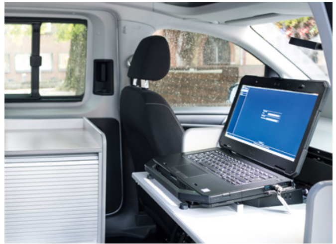
Komfortabler Arbeitsplatz mit Dockingstation, Beleuchtung und Standheizung
