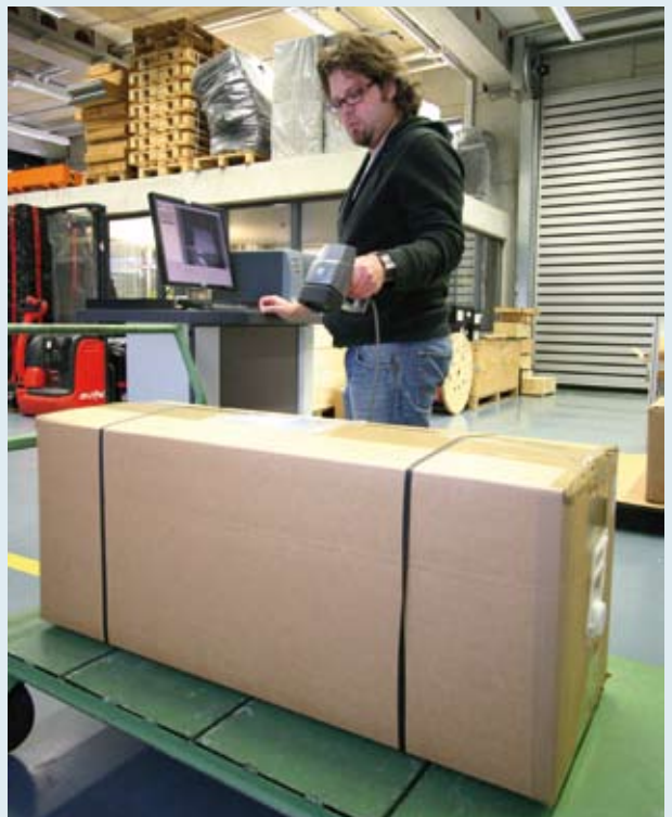
VICAM mobile OCR wird per Kabel mit einer Auswerteeinheit verbunden.
