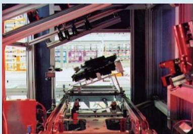
Prüfung Kühlaggregat im Durchlauf
