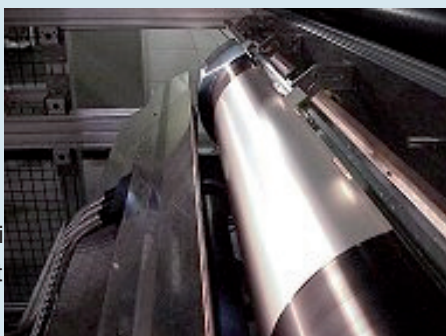
Inspektion von Folienbahnware
